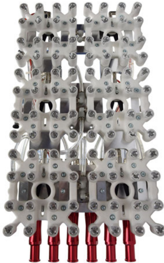
Customized Gripper 96 Cavities - Mano di presa con 96 Cavità
